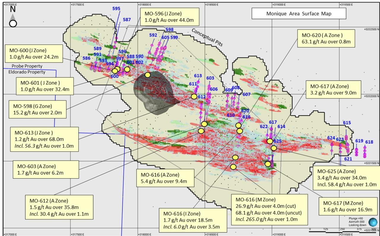
Figure 1 : Plan de surface – Nouveaux résultats de forage au gîte Monique
